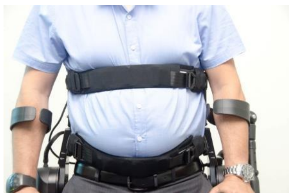
ReWalk configurato con i passanti per torace
