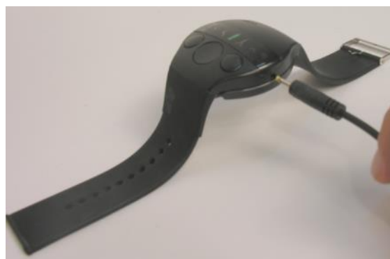
Porta di caricamento del comunicatore
