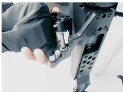
Rimozione di un supporto del ginocchio
